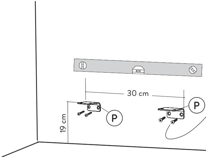
Var noga med att kontrollera väggens beskaffenhet före montering av produkt. Använd lämplig skruv och plugg för din vägg.
