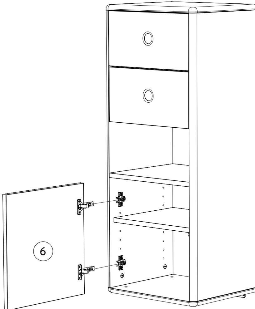
SE: Om dörren inte går att stänga - justera pushen genom att skruva ytterdelen åt något håll.
