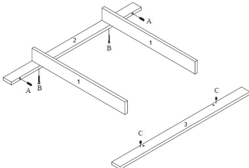
**Stap 4.1 :** Gebruik beide steunlatten **1**, de dwarslatten **2** en **3**, twee houten deuvels **A**, twee houtschroeven **B** en twee pvc inslagmoeren **C**
