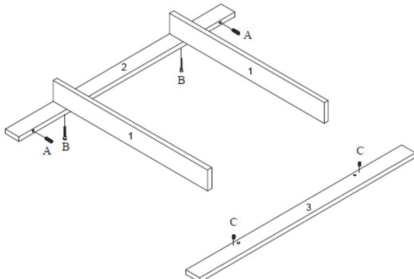
**Schritt 4.1 :** Verwenden Sie die beiden Barrieren (1), die Querlatten (2) und (3), zwei Holzdübel (A), zwei Holzschrauben (B) und zwei Pvc-Muttern (C)
