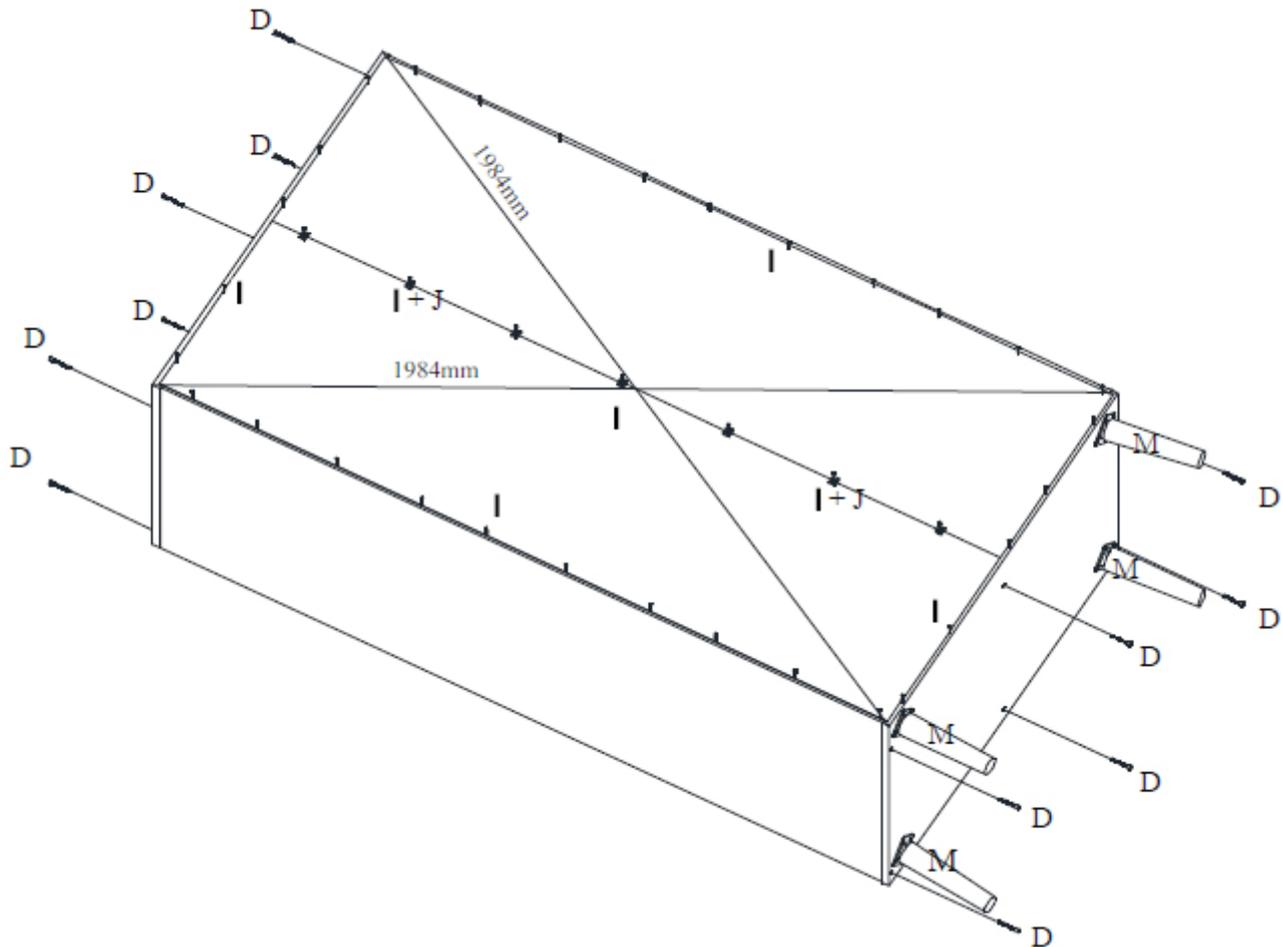
**Schritt 4.8 :** Verwenden Sie die Teile aus Schritt 4.3 und 4.4, die Konstruktion aus Schritt 4.7, zwölf Holzschrauben **D**, beide Rücken **18**, sieben Plattenklemmen **J** und siebenunddreißig Holzschrauben **I**.
