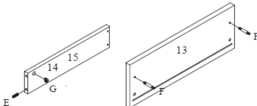
**Schritt 4.9 :** Verwenden Sie das Schubladenfront **13**, die Schubladenseiten **14** und **15**, zwei Verbindungsbolzen **F**, zwei Holzdübel **E** und zwei Minifix **G**
