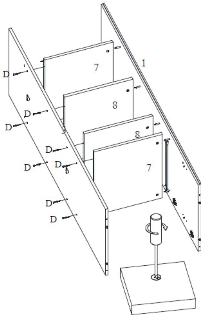
**Schritt 4.6 :** Verwenden Sie die Regale 7 und 8 von Schritt 4.5, die linke Endseite von Schritt 4.1, die Zwischenseite von Schritt 4.2 und acht Holzschrauben **D**
