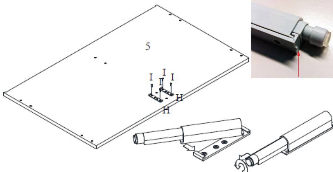
**Schritt 4.3 :** Verwenden Sie die Oberplatte **5**, zwei Drucktaste **H** und vier Holzschrauben **I**.
