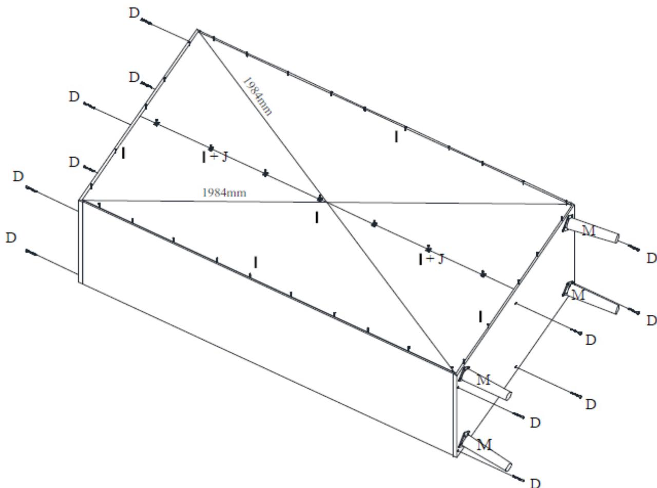
**Etape 4.8 :** Utilisez les pièces des étapes 4.3 et 4.4, la construction de l'étape 4.7, douze vis à bois **D**, les dos **18**, sept pinces de panneau **J** et trente-sept vis à bois **I**.
