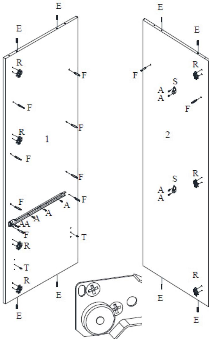
**Schritt 4.1 :** Verwenden Sie die linke Stirnseite **1**, die rechte Stirnseite **2**, acht Holzdübel **E**, zehn Verbindungsbolzen **F**, ein Führungspaar **L**, sieben Scharnierplatten **R**, zwei Kleiderstangenhalter **S**, neun Holzschrauben **A** und zwei Regalhalter **T**
