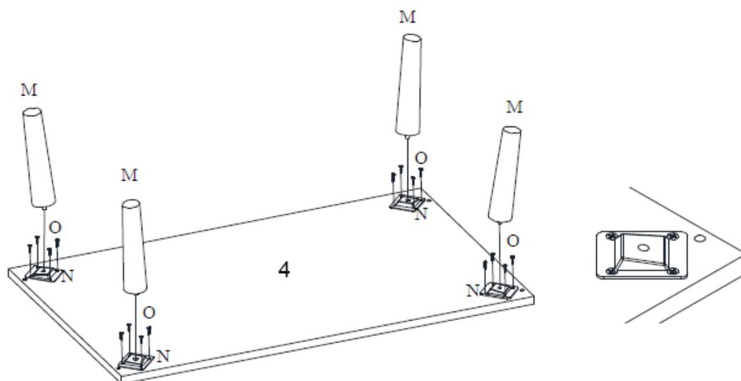
**Stap 4.4 :** Gebruik de bodem **4**, de vier poten **M**, de vier bevestigingsplaten **N** en zestien houtschroeven **O**.
