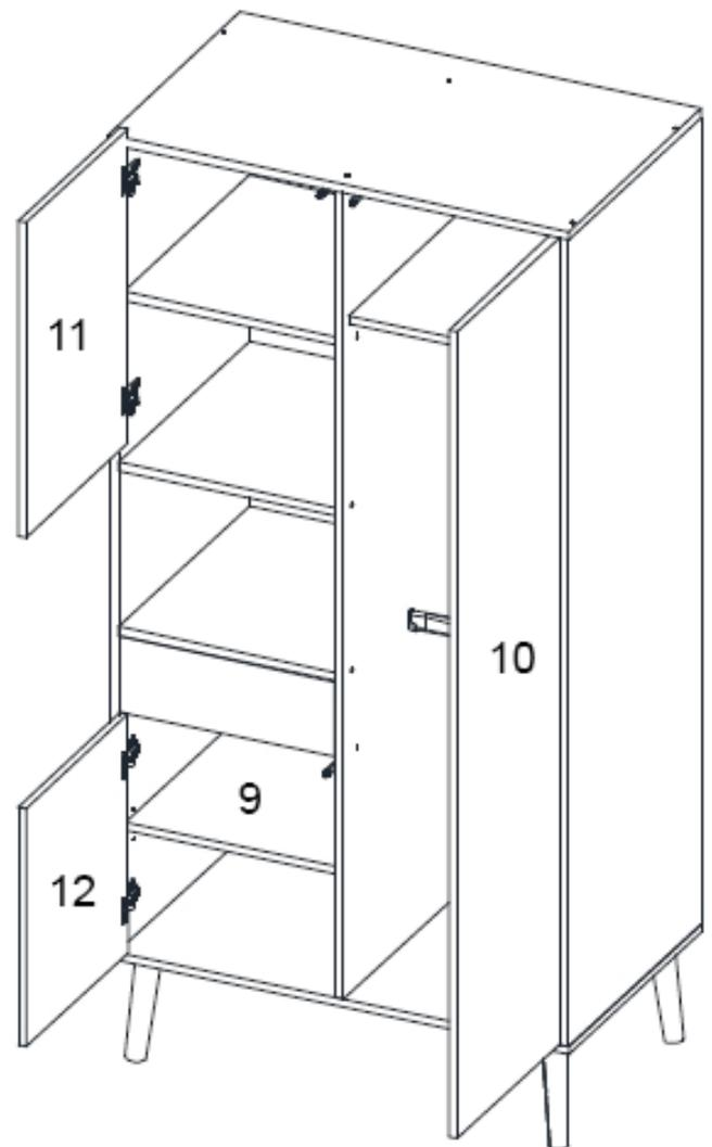
**Schritt 4.12** : Verwenden Sie die Schrankstruktur aus Schritt 4.8, die Türen aus Schritt 4.11, die Schublade aus Schritt 4.10, beide **Kleiderstangen** und das mobile Regal 9.
