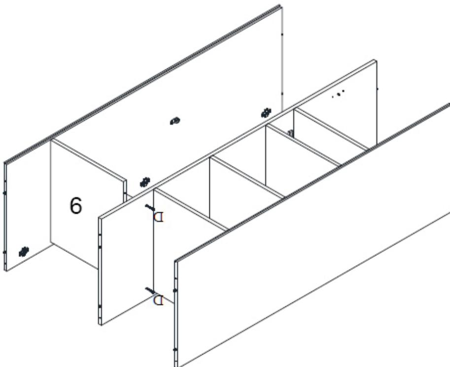
**Schritt 4.7 :** Verwenden Sie die Teile aus Schritt 4.6, das Regal 6 aus Schritt 4.5, die rechte Endseite aus Schritt 4.1 und zwei Holzschrauben **D**
