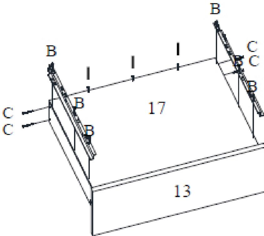
**Etape 4.10 :** Utilisez les pièces de l'étape 4.9, le dos de tiroir **16**, quatre vis à bois **C**, le fond de tiroir **17**, trois vis à bois **I**, le reste des pièces de glissières **L** et six vis à bois **B**.
