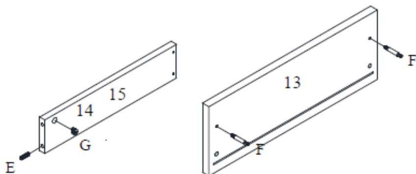
**Stap 4.9 :** Gebruik het ladefront **13**, de ladezijden **14** en **15**, twee verbindingbouten **F**, twee houten deuvels **E** en twee minifix **G**
