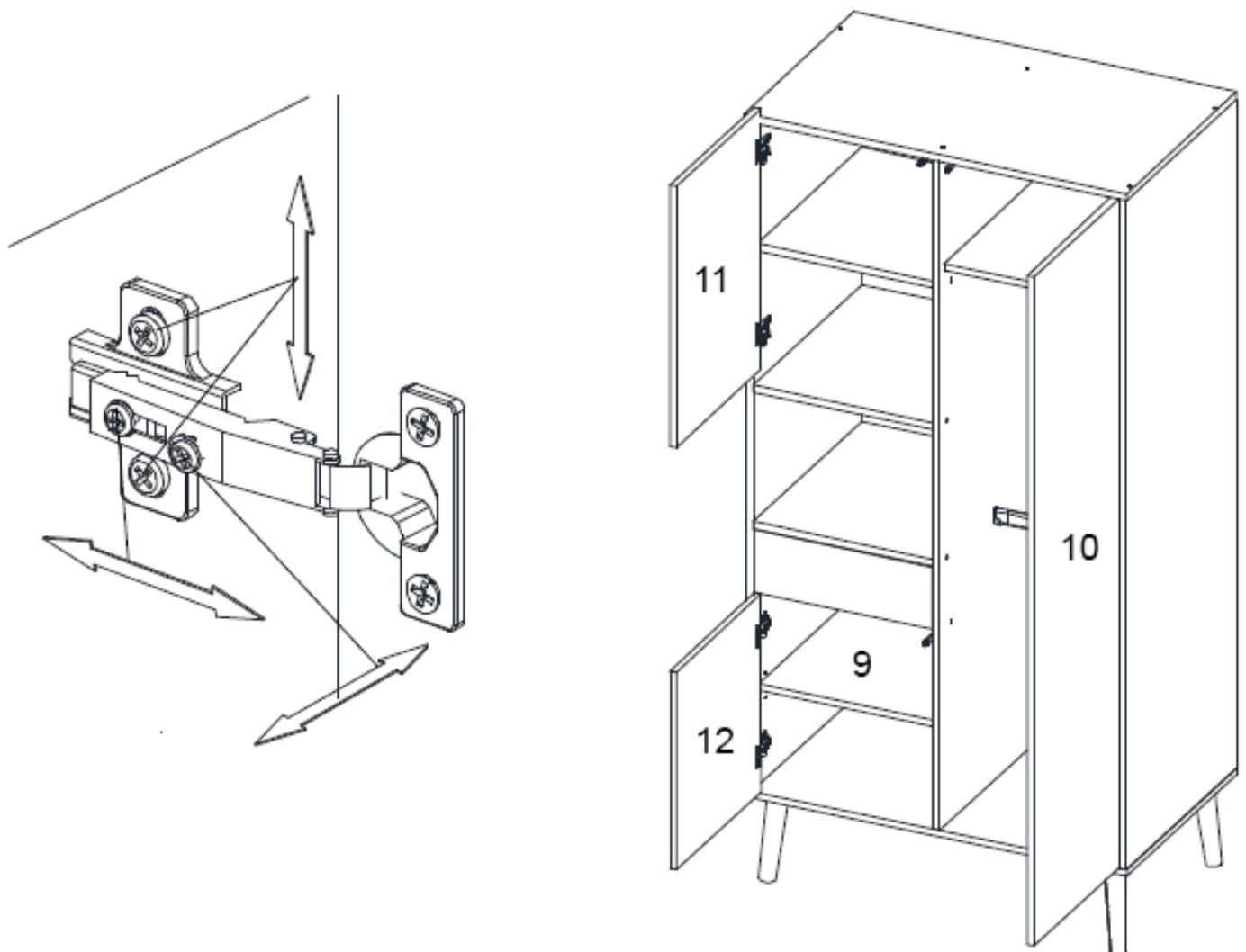
**Etape 4.12 :** Utilisez la structure d'armoire de l'étape 4.8, les portes de l'étape 4.11, le tiroir de l'étape 4.10, les **tringles** et l'étagère mobile 9.
