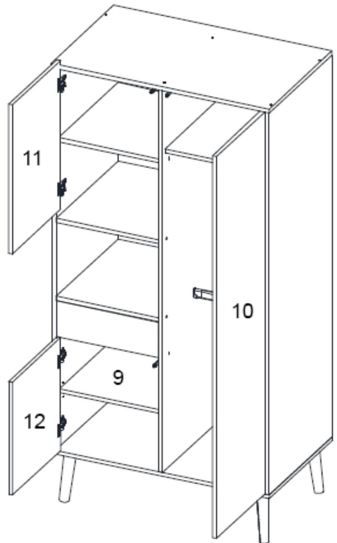
**Stap 4.12 :** Gebruik de kaststructuur van stap 4.8, de deuren van stap 4.11, de lade van stap 4.10, beide **kleerroedes** en de mobiele legplank 9.
