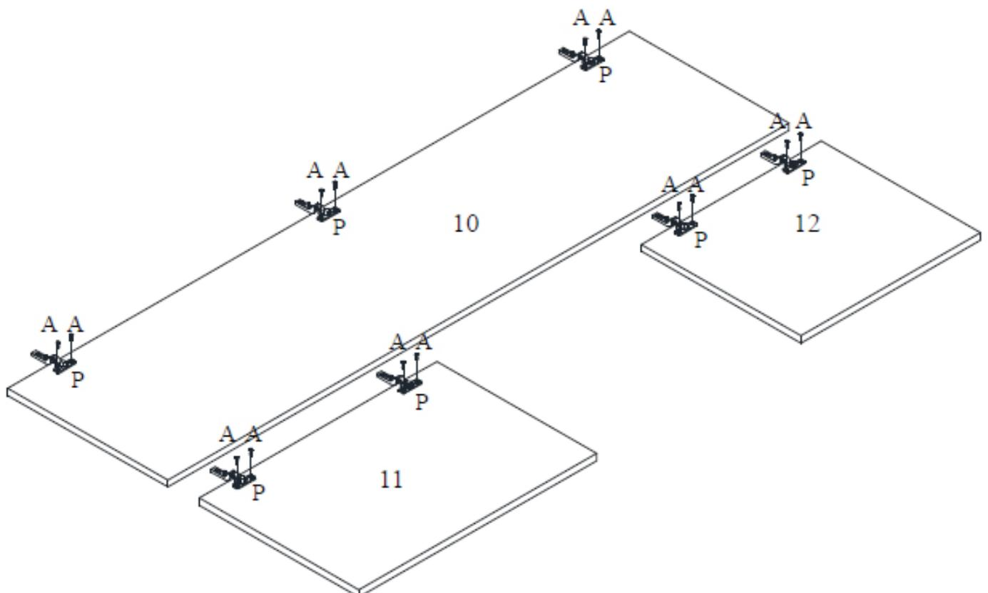
**Schritt 4.11 :** Verwenden Sie die Türen 10, 11 und 12, sieben Scharniere P und vierzehn Holzschrauben A
